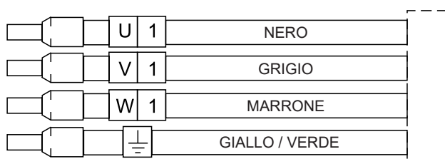
Identificazione conduttori cavo elettropompe
