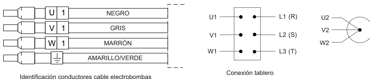
Identificación conductores cable electrobombas
